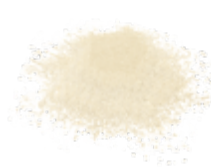
Gezaagd hout tot stof vermalen met een brandbaar oppervlakte van 1080m 2
