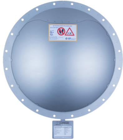
La ventana redonda tipo GT está diseñada específicamente para aplicaciones con altos niveles de Pstat. Las aplicaciones especiales con alta presión de operación requieren ventanas de explosión con presiones de apertura estáticas (Pstat) que exceden el estándar de 0.1 barg. La serie de ventanas modelo GT está disponible desde DN 200 mm hasta DN 1100 mm y se puede ajustar a niveles Pstat de hasta 0.5 bar, incluso a altas temperaturas de proceso.
